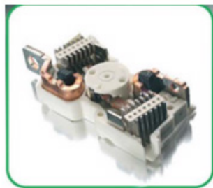
หน้าคอนแทกแบบ Roto-active ช่วยให้ตัดกระแสได้ไว ภายใน 0.002 วินาที (Current Limiting) เพิ่มประสิทธิภาพในการดับอาร์ก
